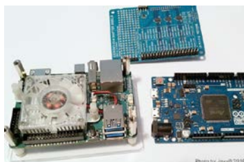
Slika 1. Odroid XU-4 SoC i Arduino DUE ARM-M3 mikrokontrolerska razvojna ploča
